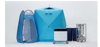
WOTAの「WOTA BOX」は、排水の98%を再生循環することにより、水道がない場所でも水利用を可能にするポータブル水再生システムです。テントなどの拡張ユニットと組み合わせれば、通常のシャワー入浴2回分に相当する100リットルの水で、約100回のシャワー入浴が可能です。電源確保さえできれば、短時間で設置できるため、災害により上下水道が断水した場合でも避難所でのシャワー入浴が可能になります。
