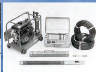
1972 高圧孔内水平載荷試験装置 エラストメータ200開発
