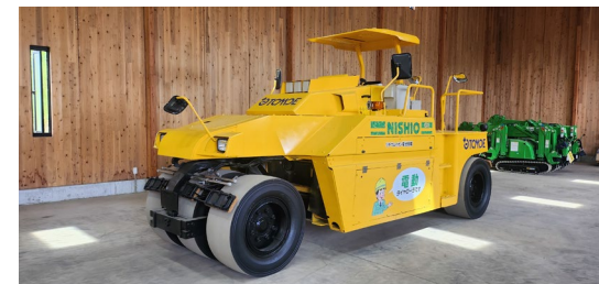
▲ 既存のエンジン式タイヤローラーを電動化
