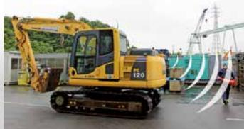
現場作業員に気づかずバック、あるいは旋回した場合でも正確に検知し、音と光でしっかり警告します。
