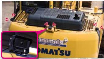
建機後方に設置した3台の特殊カメラが対象との距離を認識し、正確な空間把握を実現します。
