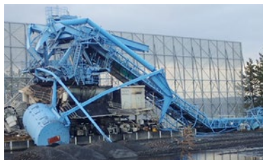
地震により倒壊した石炭払出機
