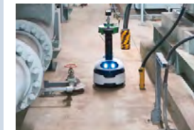
ロボットによる巡視点検実証試験
