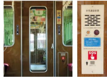
非常通報装置に加えて、車内でトラブルが発生した場合に、通報とともに乗務員と通話ができる非常通話設備の設置を進めています。(阪急電鉄)
