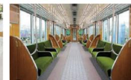
大型袖仕切りや縦手すりを設置(阪急電鉄)
