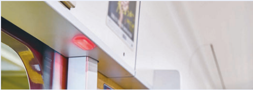
扉の開閉予告装置(阪急電鉄)
