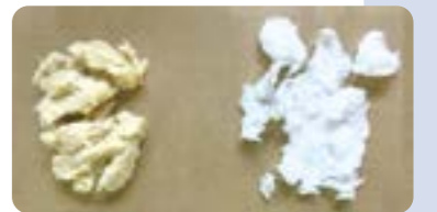
オゾン処理前(左)とオゾン処理後(右)のパルプ比較
