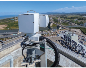
建物の屋外に設置された屋外型リモートカメラ「CR-X500」
