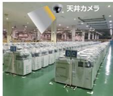
リコー環境事業開発センターの倉庫では自社開発のカラーコードを利用した回収機保管管理システムを導入しています。
