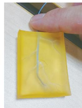
血管の中空構造を再現し、カテーテル操作のシミュレーションが可能に
