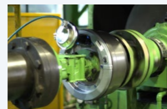
ブレーキ性能試験(本試験ではカバー付き)
