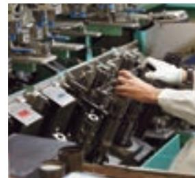
パーツ設置場所が手前にせり出す、ピストンリング組み立て機械。特許も取得している。
