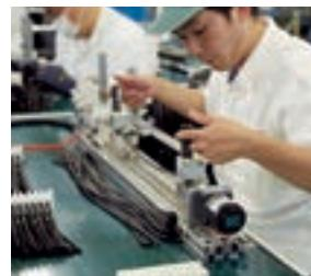
片手でも作業ができる、チューブマーキング治具。ペンとチューブをセットしてチューブを回転させると、一度で3箇所にもマーキングできる。
