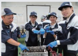
自動車用エンジン軸受を組み付ける実習
