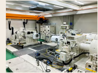
先進の試験設備(3輪ダイナモメーター)
