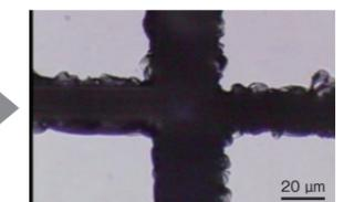
ステルスダイシング™技術は、当社が開発した「レーザを用いた全く新しいダイシング技術」です。この技術をダイシング装置搭載用にユニット化したものがステルスダイシング™です。従来技術とは異なり、水を使わずクズが出ない環境に優しい技術です。切りしろが少なく、1枚のウェーハからより多くの半導体が取れます。
