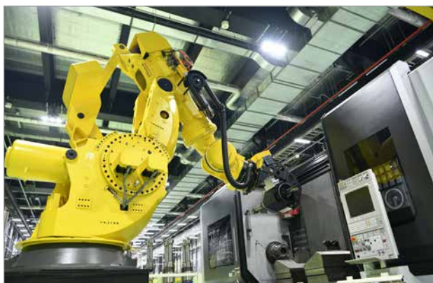
大ロボットを使用した大型部品加工セル
