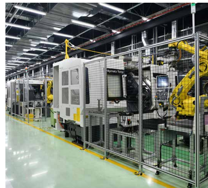
自動倉庫に接続された加工セル群
