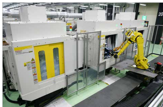
ロボドリルを使用した加工ライン
