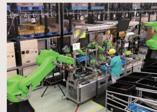
設備全景 (作業員1名、ロボット5台)
