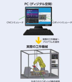
ロボットプログラムを自動生成し、プログラム作成工数を大幅に削減。デジタルツインの考えを適用し、利便性を向上
