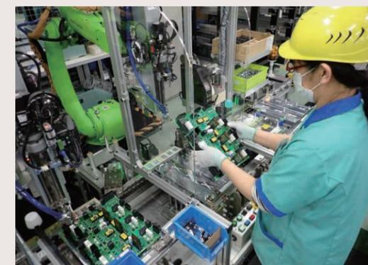
部品配置 (作業員) とねじ締め (ロボット)
