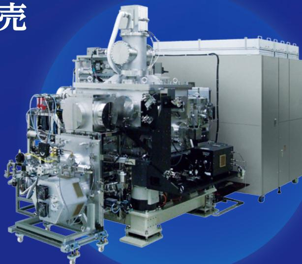
レーザーテックは、EUVマスクブランクの欠陥管理と歩留まりの向上に貢献する検査装置、EUVマスクブランクス欠陥検査/レビュー装置ABICS「E120」を製品化したしました。
