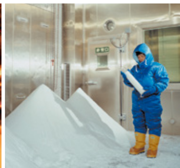
実際に雪を降らせて降雪が製品に及ぼす影響を評価
