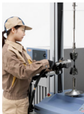
スポット冷却加熱装置 樹脂材料や接着剤などの試料に -40^{\circ}\text{C} ～ +180^{\circ}\text{C} の空気を吹きかけて温度環境下で材料試験を実施
