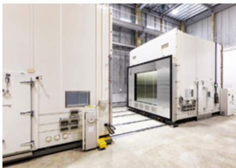
建材向け熱環境試験室(写真①) 左右2つの部屋で構成された試験室は、可動式のため建材を容易に入れ替えることができます。日射や降雨装置も備えています。
