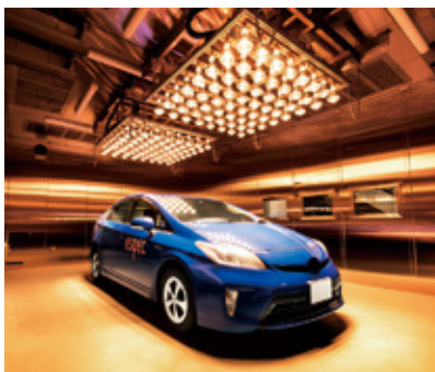
自動車を入れてさまざまな気象環境下で試験を実施(写真②)
