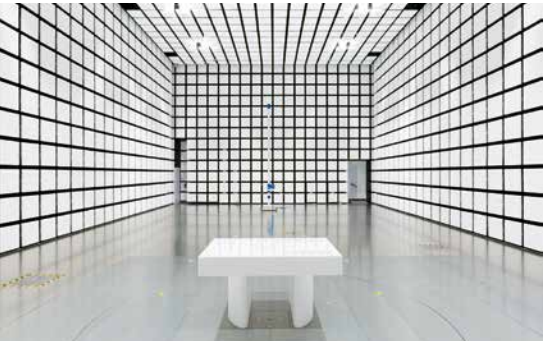
10m法電波暗室
