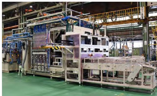
新たに開発した、3気筒～6気筒まで対応可能なクランクシャフト焼入装置
