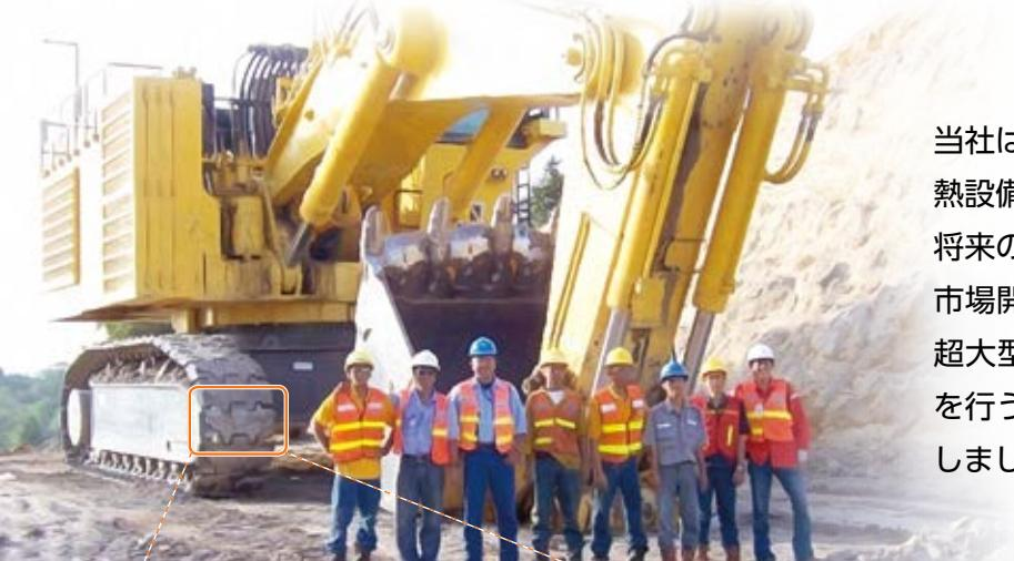
当社は、自動車関連の部品を対象とする誘導加熱設備において大きなシェアを持っていますが、将来の成長と発展のために、自動車関連以外の市場開拓も積極的に進めています。第91期は、超大型建設機械に使われる部品の焼入れ処理を行う、非常に難易度の高い設備を完成・納入しましたので、こちらで紹介します。
