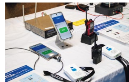
無線機とスマートフォンの相互通信 公共回線エリア外でも相互通信できる新たな無線ネットワーク
