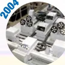
明電舎独自の画像解析技術を用いた鉄道事業者向け架線検測装置を開発。架線の摩耗状況の確認・点検をリアルタイムで検測。
