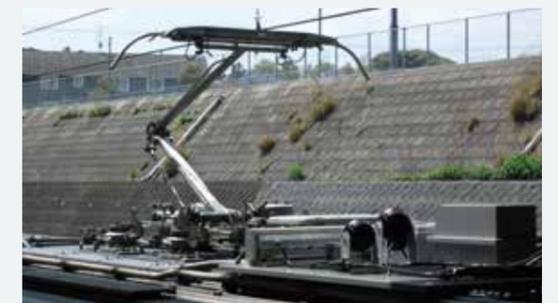
架線検測装置 カテナリーアイを搭載した鉄道車輛
