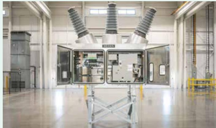
MEIDEN AMERICA SWITCHGEAR, INC.で組み立てている72.5kV エコタンク形真空遮断器
