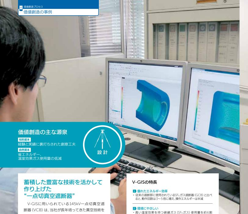
基にして開発されました。従来の145kV電圧クラ スの単体の真空遮断器は、1相あたり真空インタラ プタを2個直列で使用していましたが、これを1相 あたり1個のみとして絶縁筒をガラス製からセラ ミック製に変更し、電流遮断可能な高性能の真空 インタラプタを開発しました。
