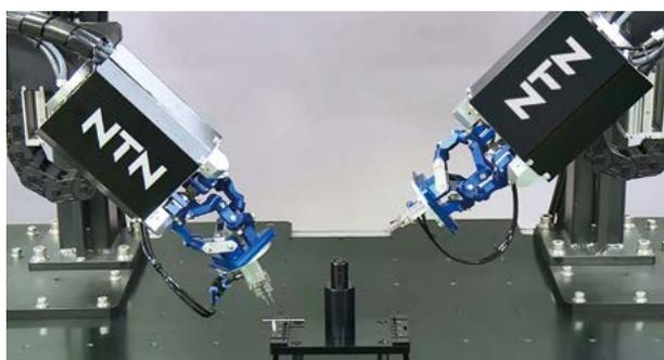
パラレルリンク型高速角度制御装置
