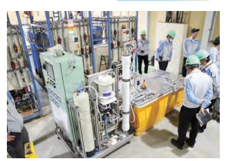
めっき排水処理システム実証機
