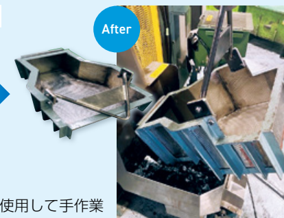
専用のボックスを製作し、クレーンで投入できるよう改善
