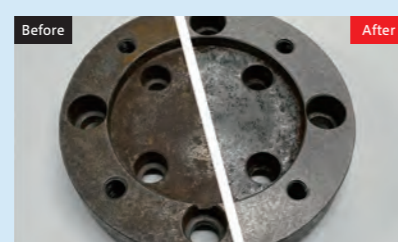
レーザークリーニングによる錆の除去。 加工前(左)と加工後
