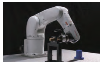
ZYXer®を搭載したロボットによるシャフトの嵌合
