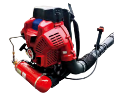
水素エンジンを用いたブローワー試作機
