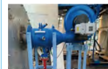
世界初となるアンモニア変換の水素を利用した水素バーナ対応型アスファルトプラントの開発に着手(2022年)
