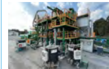
水素専焼でのアスファルト混合物の製造及び試験施工を実施(2023年)
