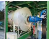
水素専焼でのアスファルト混合物の製造及び試験施工を実施(2023年)
