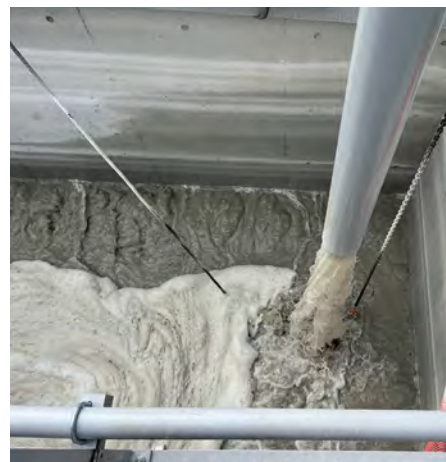
産業廃棄物としてのコンクリートスラッジ
