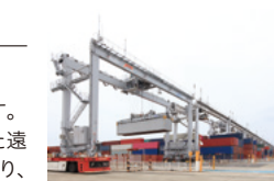
遠隔操作RTG
