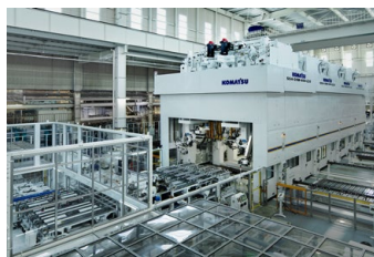
大型ACサーボプレス （コマツ産機）
