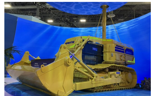
水中施工ロボット
