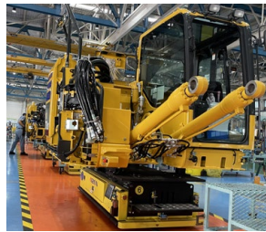
組立ラインで稼働する AGV
