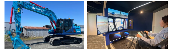
株式会社 横瀬で保有するシステム対応の油圧ショベル（左）と同社に提供した Smart Construction Teleoperation のコックピット（右）
