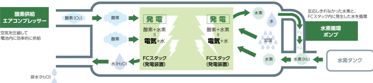
る水素循環ポンプに加湿器の役割も与えることになりましたが、水素循環ポンプで循環する水分を増やすと、停車時にポンプ内部に残る水も増え、極低温時にはその水が凍結。発電の始動が困難になるという問題が発生します。そこで、ポンプ内の構造などを見直すことで、システムの低温始動性の向上と加湿器レスを実現することに寄与しました。
