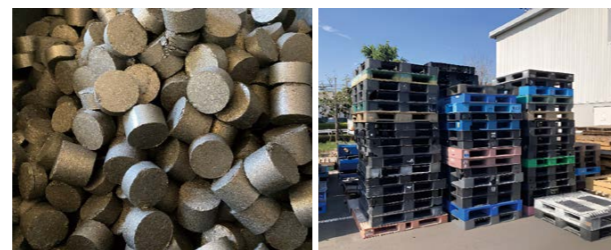
金属の切りくずを圧縮し、再利用しやすくしています
