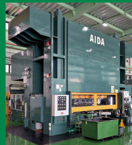
新開発した角形蓄電池ケース成形専用機DPH-80-30
