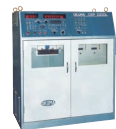
1972年 世界初の実用化CNC OSP2000
