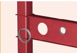
OSリングは、梁の鉄骨に空調などの貫通孔を設ける際、欠損した梁の補強として耐力を確保するために用いる特殊な金物です。各種実大実験及び部分実験を行い、耐力・剛性・変形性能等の構造性能を確認し、それらのデータをもとに(一財)日本建築センターの評定を取得しております。
