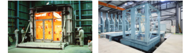
「桶川テクニカルセンター」に導入された民間初の耐火試験炉
