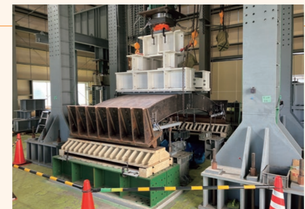
五面鋼殻合成セグメントの曲げ性能確認試験
