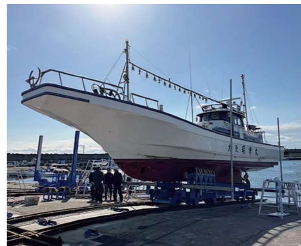
大洗漁港 船舶上架施設
