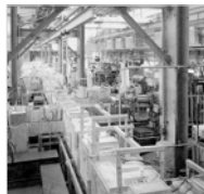
アルミ溶湯を鑄造機まで全自動で送るロンダーシステムを日本で初めて採用(東松山工場)
