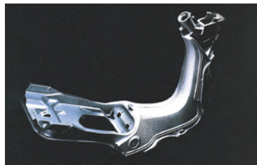
スクーター用アルミダイカスト製一体モックフレームを世界で初めて量産化
