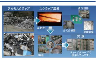
アルミ二次合金は、アルミ缶、自動車のナンバープレートやホイール、アルミサッシ、鍋など、さまざまなアルミスクラップからリサイクルされます。 牛野株式会社(兵庫県朝来市)では、アルミニ次合金を製造しています。製造された二次合金は、国内グループ各工場で高品質なダイカスト 製品に生まれ変わっています。
