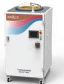
\*1 Blue-IRハイブリッドレーザー…日亜化学工業(株)と共同開発した高輝度青色レーザーダイオードモジュールを搭載した高出力青色発振器と近赤外(IR)シングルモードファイバレーザーを組み合わせたハイブリッドレーザー
