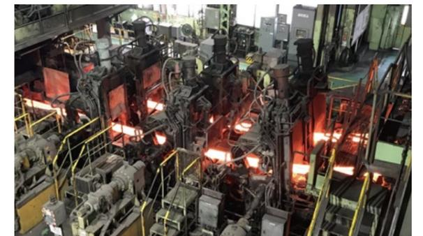
CO<sub>2</sub>排出削減と生産能力の上方弾力性確保に向けて開発中の小断面連続製造機
