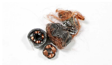
キャノンエコロジーインダストリーが回収した複合機から取り出した鉄 (左:銅が付いた状態の鉄、右:純度99%に分別した鉄)
