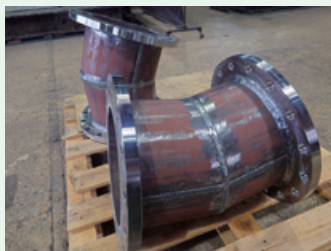
粉体圧送エルボ配管
