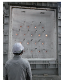
燃料転換を実施した耐火炉による耐火試験の様子
