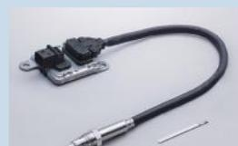
車載用高精度NOxセンサー
